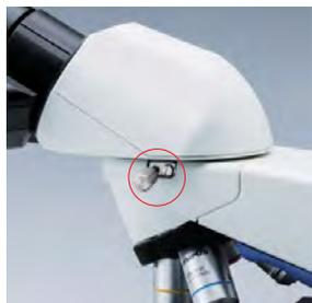
Специальный винт, фиксирующий бинокулярную насадку.
