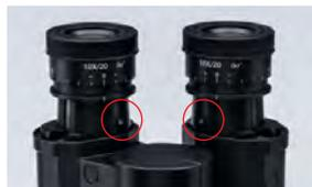
Окуляры зафиксированы в окулярных трубках винтами для предотвращения их повреждения при переноске прибора. Диоптрийная настройка на обоих окулярах.
