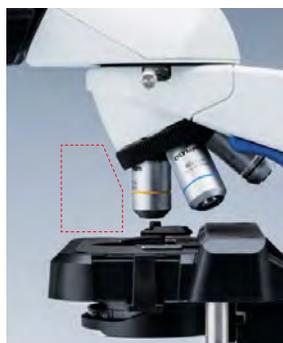
Направление объектива в револьвере "от пользователя" дает больше места для смены препаратов и использования иммерсионного масла при работе с иммерсионным объективом.
