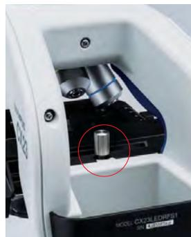
Фиксатор положения фокуса для предотвращения повреждения препарата при фокусировке.
